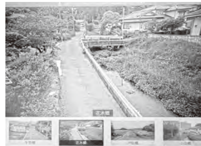
▲河川等監視システムの表示画面。町内を流れる「矢矧川・汐入川・野間川・篠間川・戸切川」の河川水位や、道路の冠水状況を確認するためにカメラを設置している
